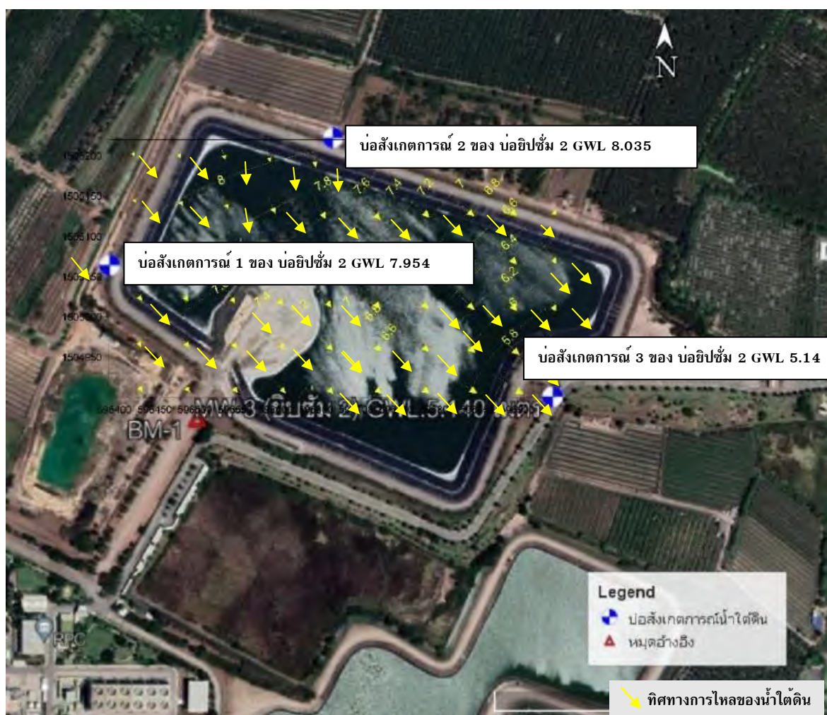
รูปที่ 3.2.7-3 ทิศทางการไหลของน้ำใต้ดิน โครงการสำรวจบ่อสังเกตการณ์น้ำใต้ดินและตรวจสอบการปนเปื้อนในน้ำใต้ดิน บริเวณบ่อสังเกตการณ์ของบ่อยิปซัม 1 และ 2 โรงไฟฟ้าราชบุรี
